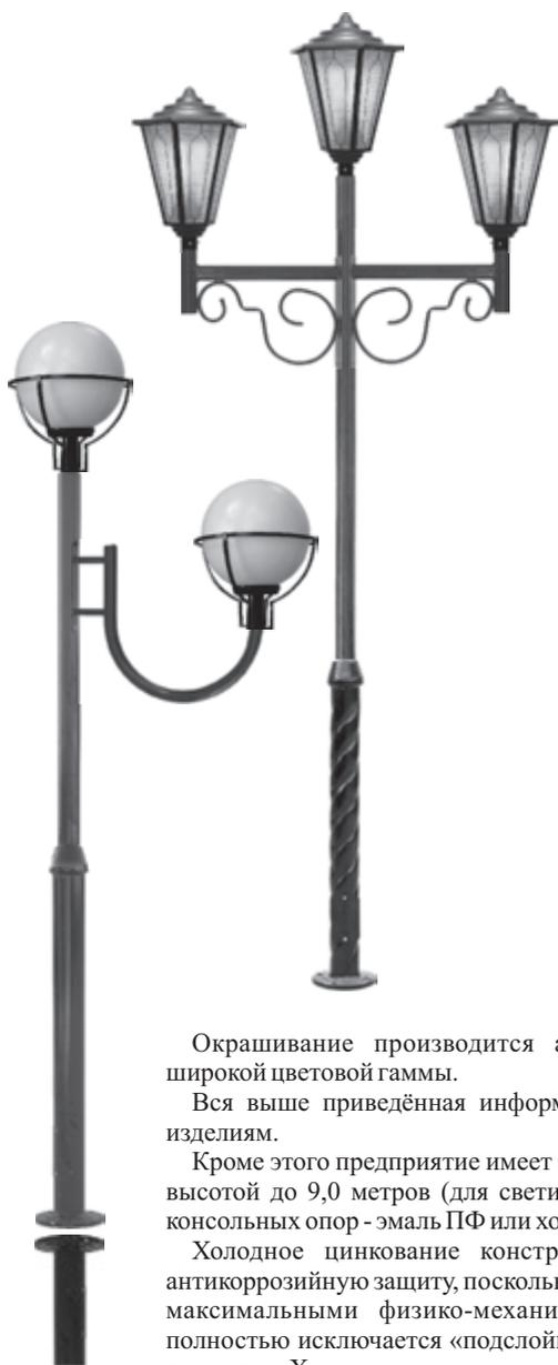
Опоры торшерные для садово-парковых светильников высотой до 5-ти метров. Опоры изготовлены из труб круглого сечения и состоят из двух частей. Соединение частей опоры осуществляется с помощью полуавтоматической электросварки и усилено специальным переходом, изготовленным методом горячей штамповки.
